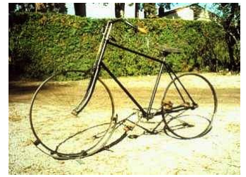
Bicyclette de 1890 à cadre classique et transmission par chaîne
